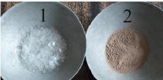
Рисунок 1 - Загальний вигляд зразків: 1 – подрібненого пластику фракція 2 мм; 2 – суглинок лесовий.
